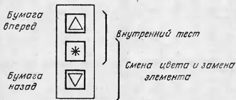
Рис. 5. Клавиатура графопостроителя. Клавиша, обозначенная звездочкой, изменяет функции двух остальных
