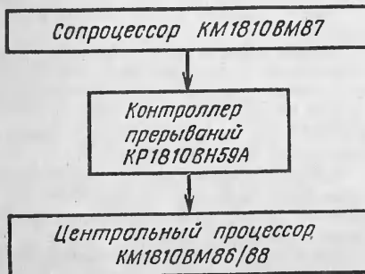
Рис. 6. Типичный путь прохождения сигнала запроса на прерывание
